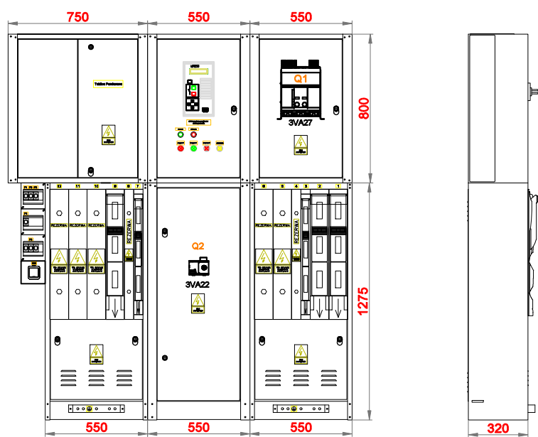
Widok zewnętrzny i gabaryty rozdzielnicy
